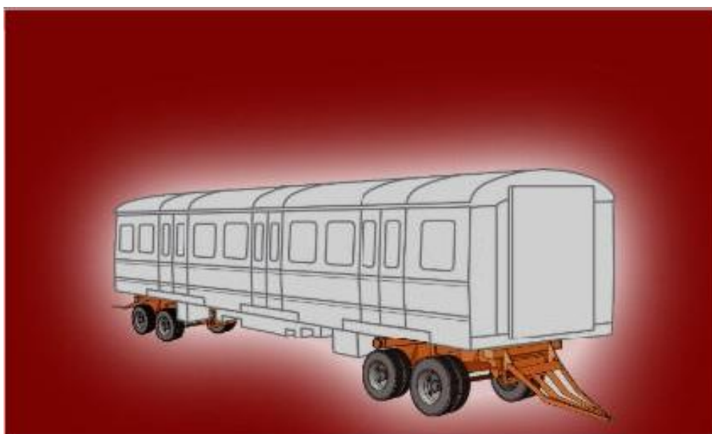
Slika 9.: RO-RO prikolica za isključivo masivni teret
