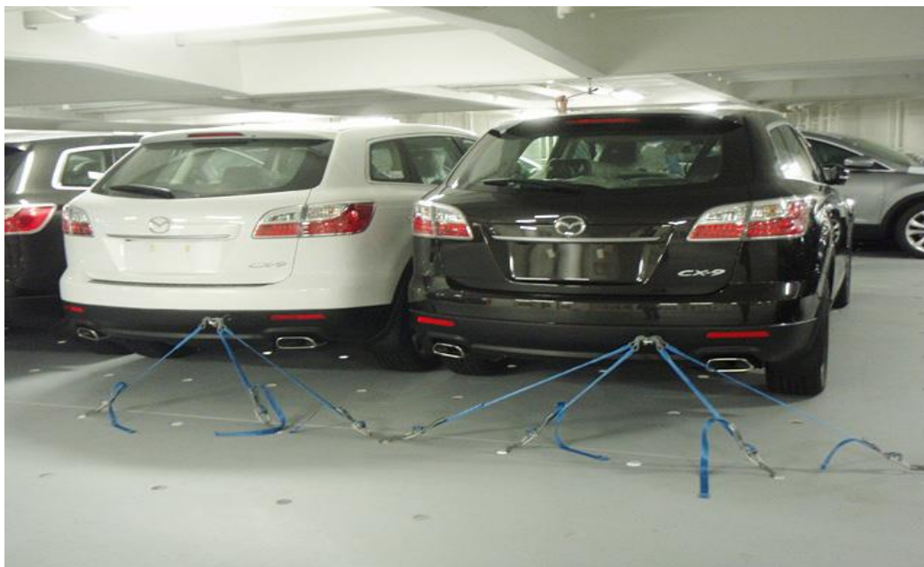
Slika 15.: Točke zahvata na cestovnim vozilima
