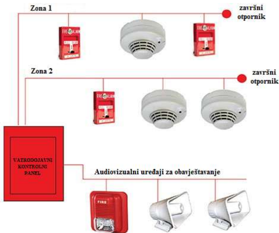
Slika 20. Pojednostavljeni prikaz klasičnog vatrodojavnog sustava
