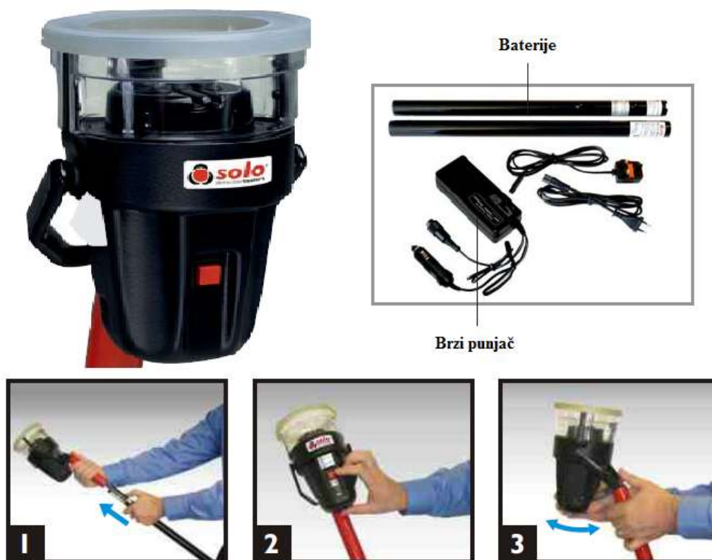
Slika 16. Prikaz seta i priprema za testiranje toplinskog detektora
