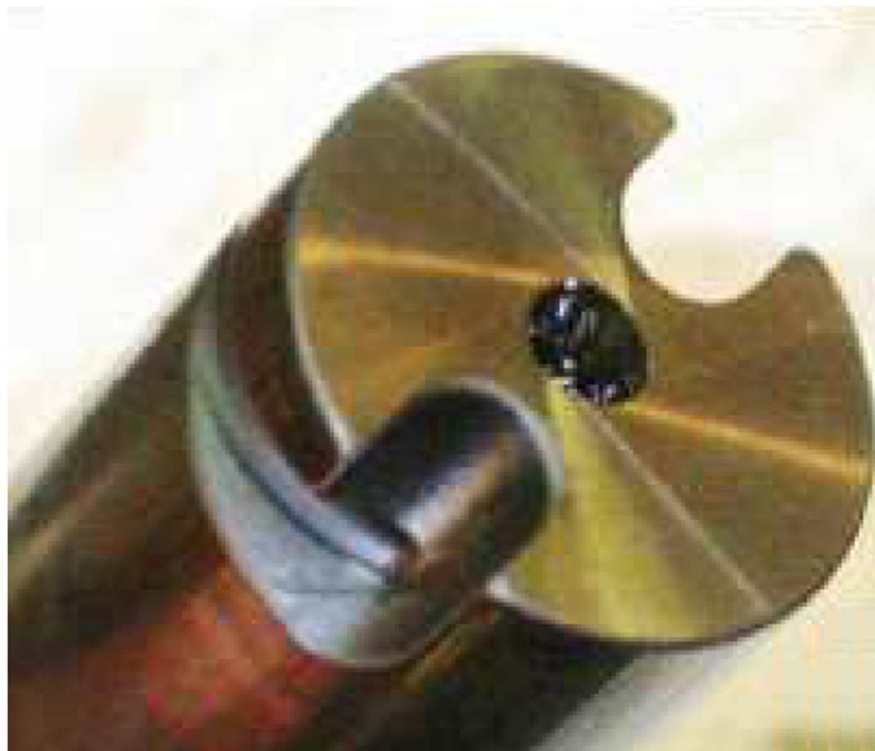
Slika 38. Vrh klipa pumpe goriva s regulacijskim utorima [2]
