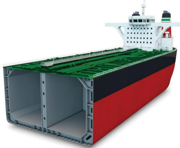
**Slika 5. Presjek tankera s dvostrukom oplatom**
