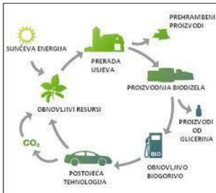
Slika 4. Shematski prikaz cirkuliranja CO 2 kod uporabe biogoriva
