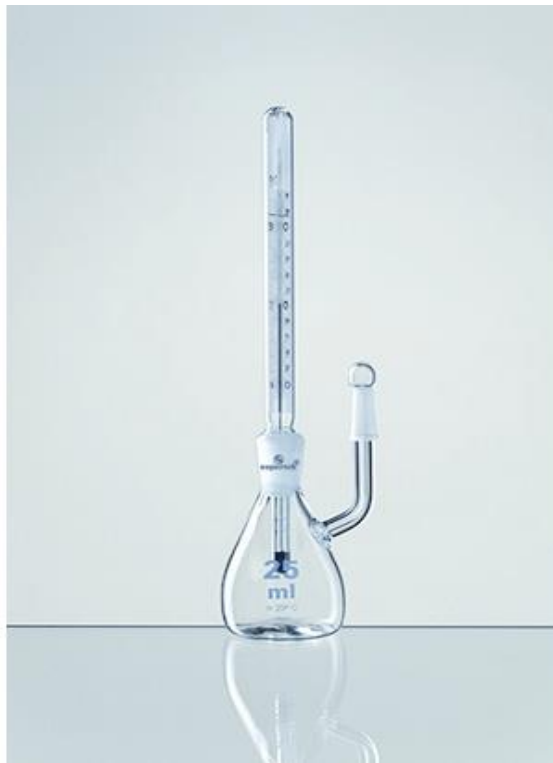
Slika 8. Piknometar s termometrom [16]
