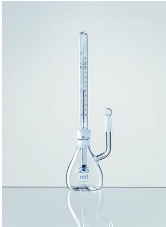
Slika 8. Piknometar s termometrom [16]
