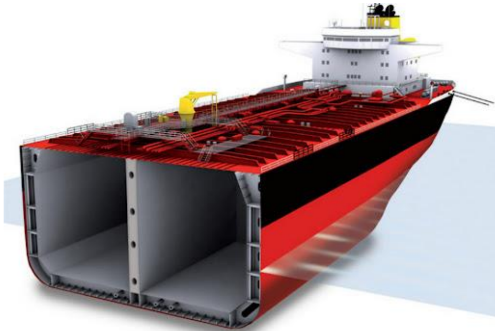
Slika 14. Tanker za prijevoz ulja
