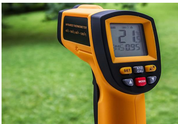
Slika 4. Točkasti infracrveni termometar
