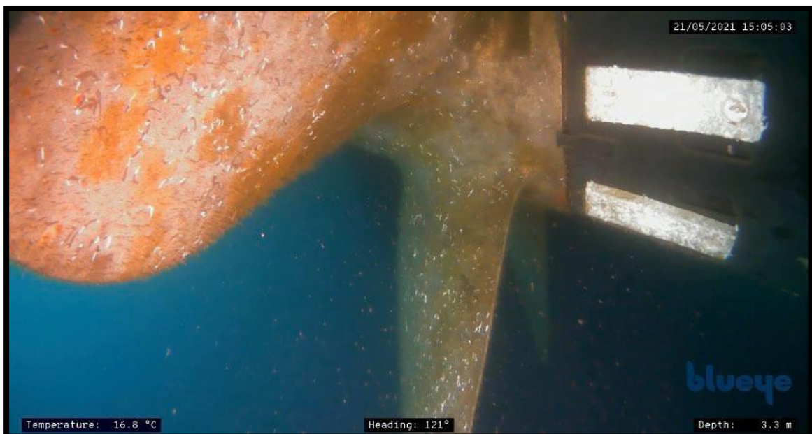
Slika 27. Krila vijka i žrtvene anode
