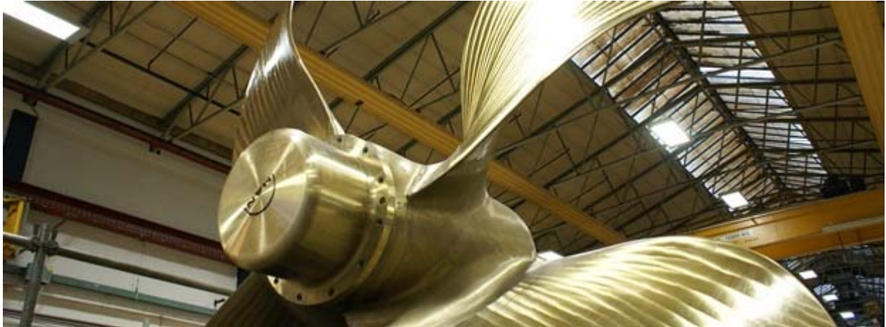
Slika 2: Brodski vijak s fiksnim krilima (FPP) [14]
