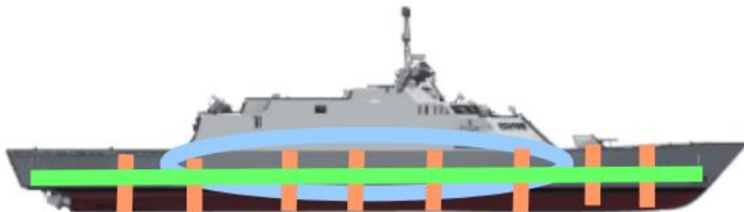
Slika 10: Konceptualni prikaz sustava AGD u američkim razaračima
