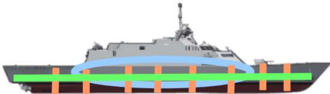
Slika 10: Konceptualni prikaz sustava AGD u američkim razaračima
