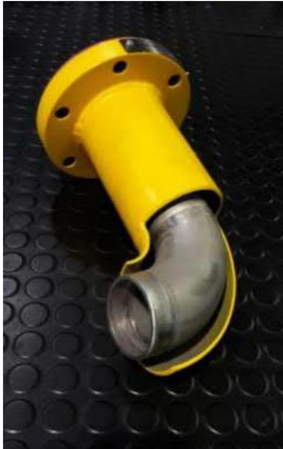
Slika 19: Stvarni prikaz cijevi sa dvostrukom stijenom [3]
