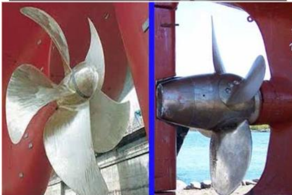
Sl. 7. Brodski vijak s promjenjivim korakom [12]
