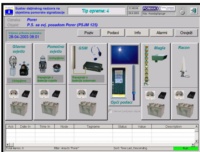
Slika 26 SCADA iFIX računalni program – ekran tipa opreme
