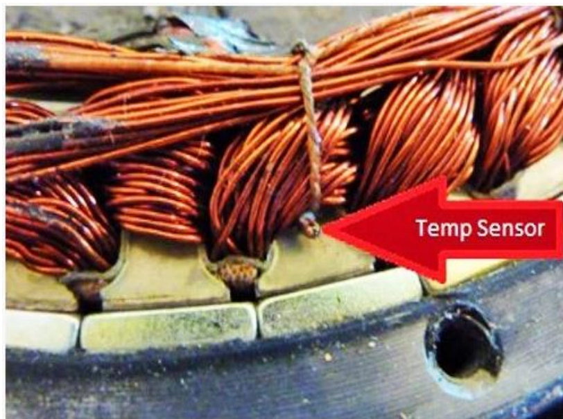
Slika 9 Temperaturni senzor u namotaju
