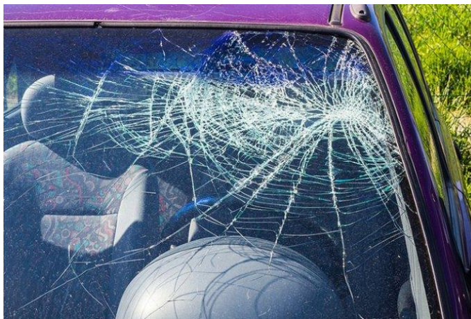
Slika 2. Karakteristično oštećenje vetrobranskog stakla nastalo usled kontakta sa pešakom
