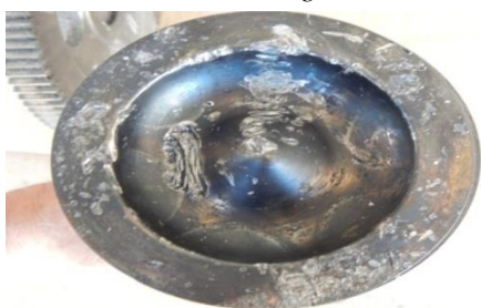
Slika 19. Oštećeno čelo klipa šestog cilindra pogonskog motora
