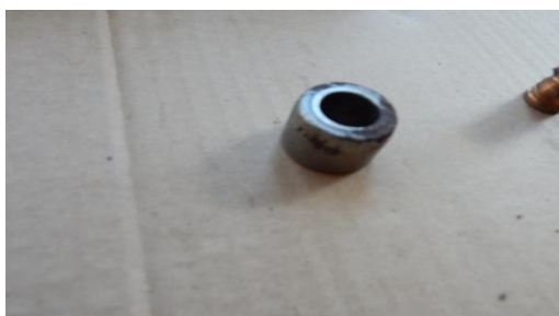
Slika 11. Pogled na oštećenu rolnicu koja usmerava kretanje šipke podizača šestog izduvnog ventila pogonskog motora
