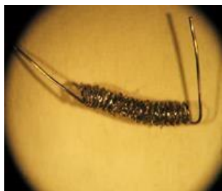
Slika 2. Spiralno vlakno sa istopljenim staklenim fragmentima iz staklenog balona (levo) i bliži pogled na istopljene fragmente stakla (desno)
