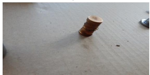
Slika 12. Pogled na oštećenu osovinicu rolnice koja usmerava kretanje šipke podizača šestog izduvnog ventila pogonskog motora
