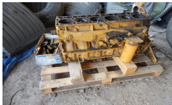
Slika 4. Pogonski motor - blok havarisanog motora
