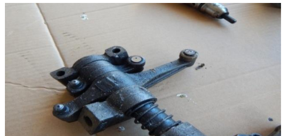
Slika 10. Pogled na klackalicu koja dodiruje glavu iznad šestog cilindra, pogonskog motora - povećan zazor koji omogućuje i aksijalno pomeranje i klaćenje klackalice šestog izduvnog ventila
