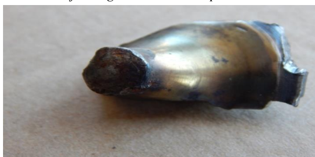
Slika 18. Polomljeni deo izduvnog ventila - pečurke ventila na šestom cilindru pogonskog motora
