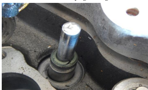
Slika 17. Vođica izduvnog ventila na šestom cilindru pogonskog motora -sa delom polomljenog stabla izduvnog ventila
