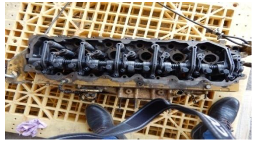
Slika 6. "Klavijatura"- nosač klackalica pogonskog motora - celokupan izgled
