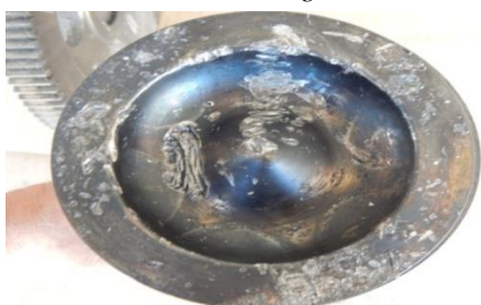
Slika 19. Oštećeno čelo klipa šestog cilindra pogonskog motora
