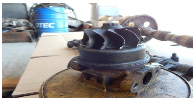
Slika 20. Oštećene lopatice turbine pogonskog motora
