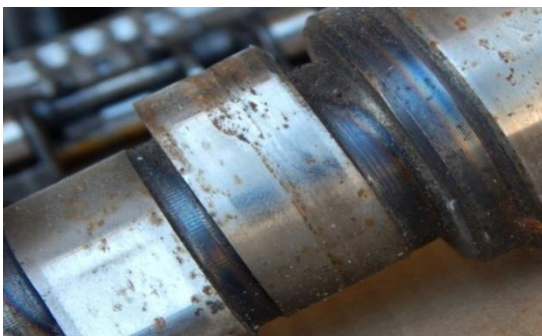
Slika 3. Bregasta osovinica pogonskog motora -oštećenje brega šestog izduvnog ventila
