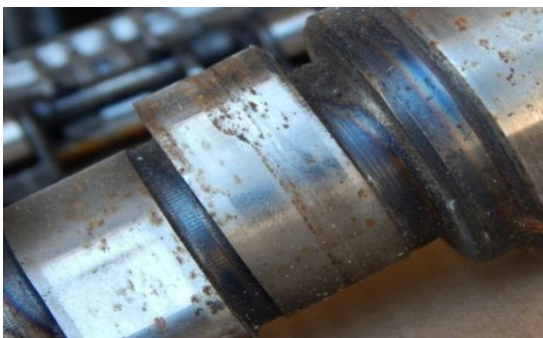
Slika 3. Bregasta osovina pogonskog motora -oštećenje brega šestog izduvnog ventila
