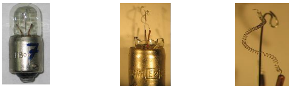
Slika 4. Sijalica za automobil sa netaknutim balonom i deformisanim vlaknima(levo),vidljiva deformacija vlakana (u sedini) pogled izbliza na deformacije vlakana (desno)
