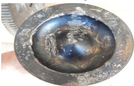
Slika 19. Oštećeno čelo klipa šestog cilindra pogonskog motora
