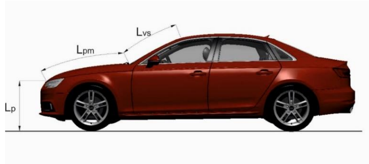
Slika 5. Karakteristične visine na prednjem delu vozila za utvrđivanje parametra WAD
