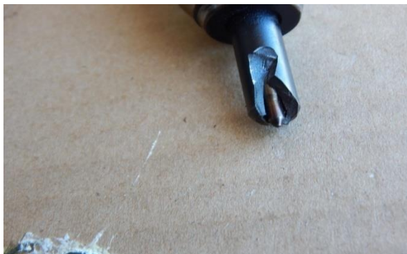
Slika 13. Oštećen brizgač - injektor šestog cilindra pogonskog motora
