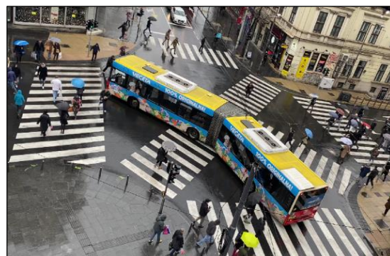
Slika 1: Autobus pri levom skretanju blokira raskrsnicu i ometa prelazak pešaka, za vreme trajanja ekskluzivne pešačke faze (Kovač, 2020)
