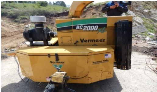
Slika 1. Drobilica za drvo Vermeer BC 2000XL - prednji izgled
