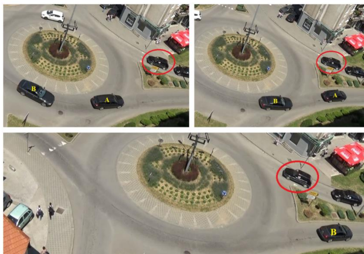
Slika 1. Uticaj vozila na izlazu iz kružne raskrsnice na odluku vozača na sporednom prilazu da stupi u zonu kruženja
