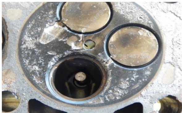
Slika 14. Pogled na oštećenu glavu motora, oštećeno sedište ventila i polomljen izduvni ventil na šestom cilindru pogonskog motora
