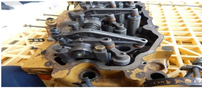
Slika 5. "Klavijatura"- nosač klackalica pogonskog motora - celokupan izgled
