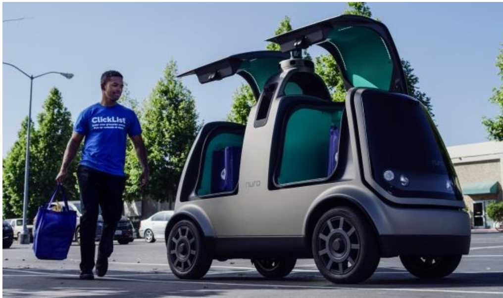
Slika 2. Autonomno vozilo tvrtke Nuro za dostavu pošiljaka [19]
