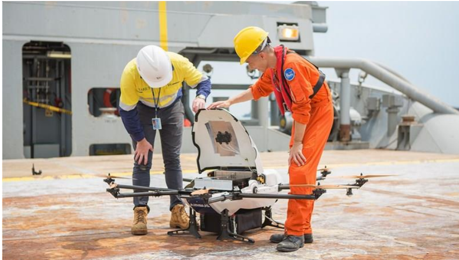
Slika 10. Slijetanje drona Airbus Skyways na palubu broda M/V Pacific Centurion [39]
