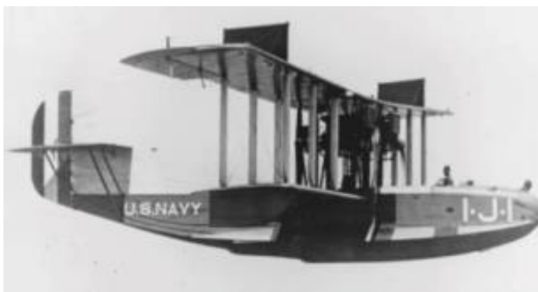
Slika 4. Zrakoplov F-5L daljinski upravljani u svim fazama leta (polijetanje, manevar i slijetanje) iz 1924. godine [24]
