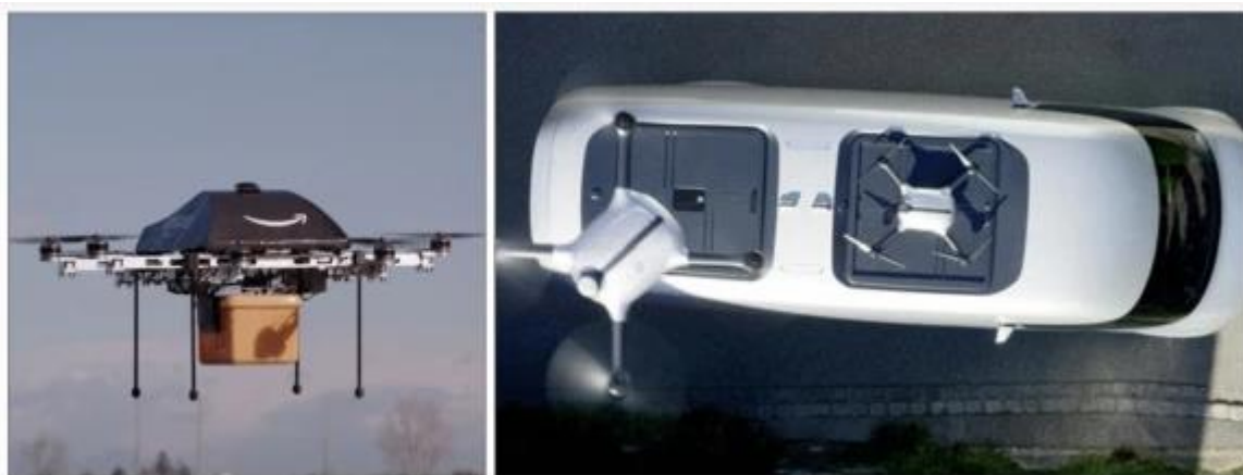
Slika 7. Dron za dostavu paketa (lijevo), lansiran iz kombija (desno) [22]
