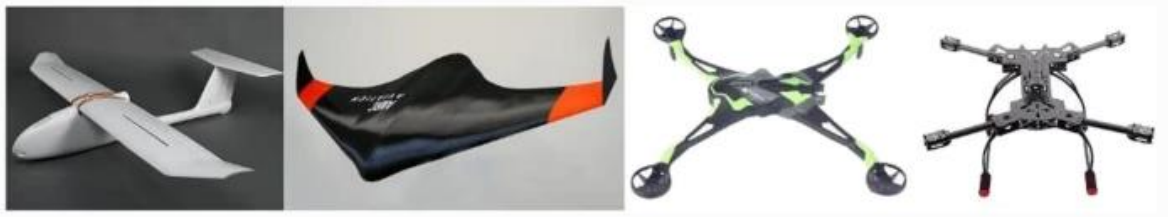
Slika 6. Različite konstruktivne strukture zrakoplova s obzirom na materijal: polistiren, plastika, aluminij, karbonska vlakna (od lijeva ka desno) [29]
