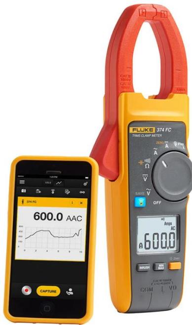
*Slika 18. Fluke 374 mjerna kliješta s prikazom mjernih podataka na pametnom mobilnom uređaju [12]*
