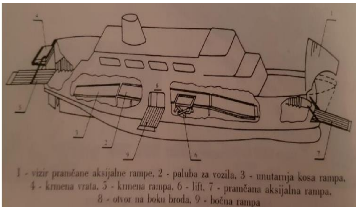
Slika 5. Glavni dijelovi RO-RO broda
