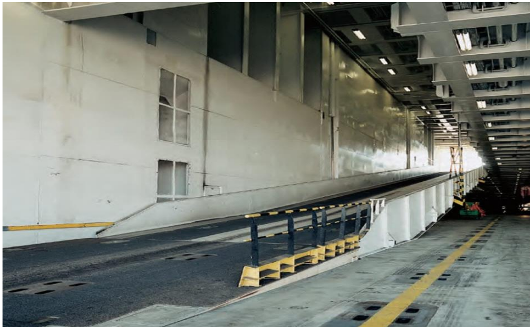
Slika 17. Unutarnja brodska rampa
