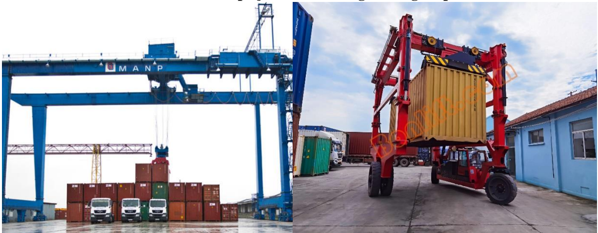
Slika 3. Portalni prijenosnik velikog i malog raspona
