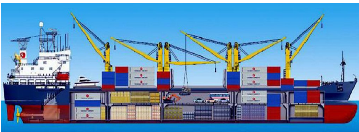
Slika 13 Moderni brod za prijevoz generalnog tereta, nosivost svake dizalice je 25 T
