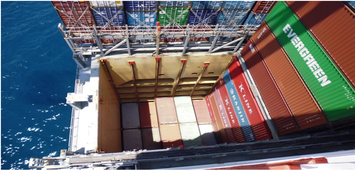
Slika 17 Ukrcani kontejneri u skladištu i na palubi kontejnerskog broda
