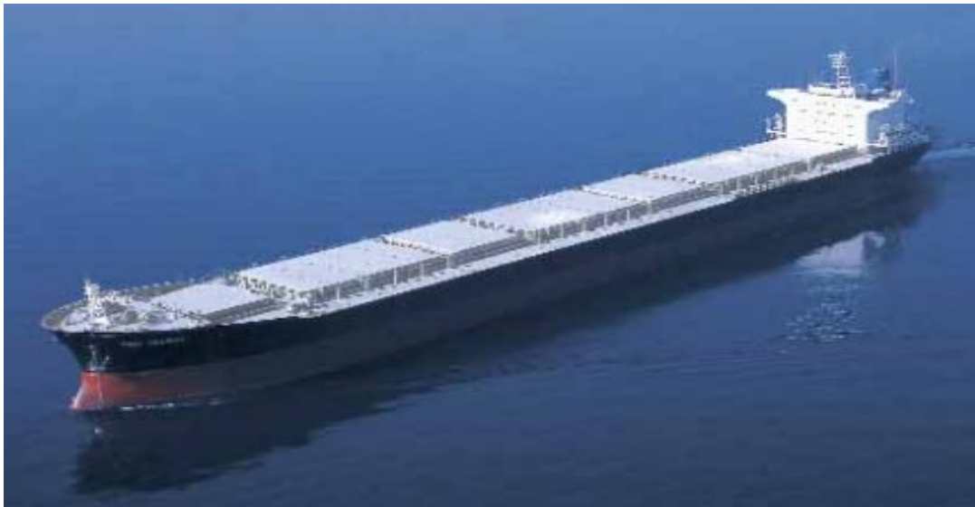
Slika 14. m/s CAST CARIBOU, izgrađen 1981. god. u brodogradilištu Treći Maj u Rijeci, ima 7 skladišta a kontejnere može prevoziti u skladištima br. 2, 4 i 6.
