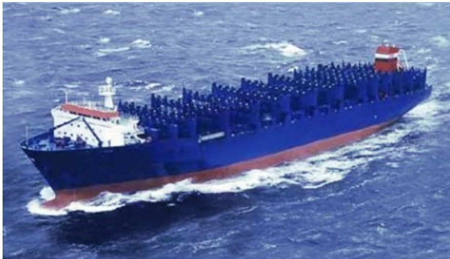
Slika 20 Kontejnerski brod sa nadgrađem po pramcu i sustavom vodilica po cijeloj dužini broda
