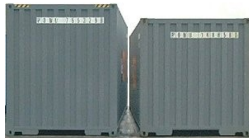
Slika 8 High cube (9' 6\") i 8' 6\" kontejneri
