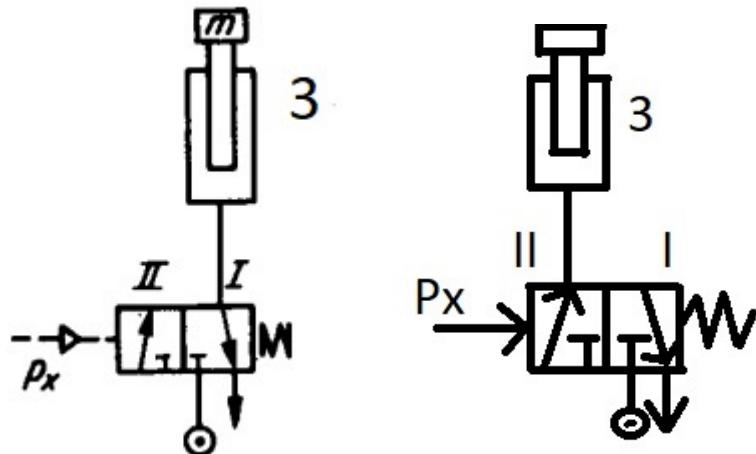
Slika 1: Pneumatski 3/2 razvodnik [1]
