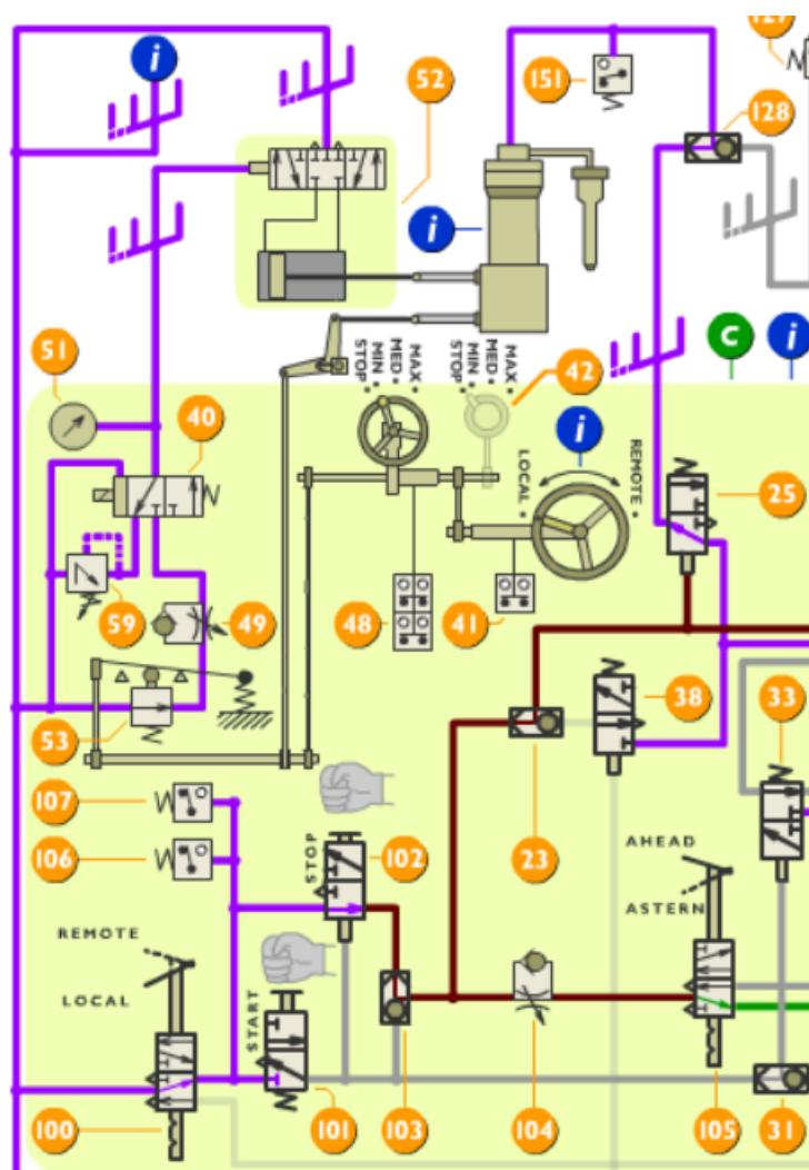
Slika 8. Zaustavljanje motora otvaranjem preljevnih ventila. [4]
