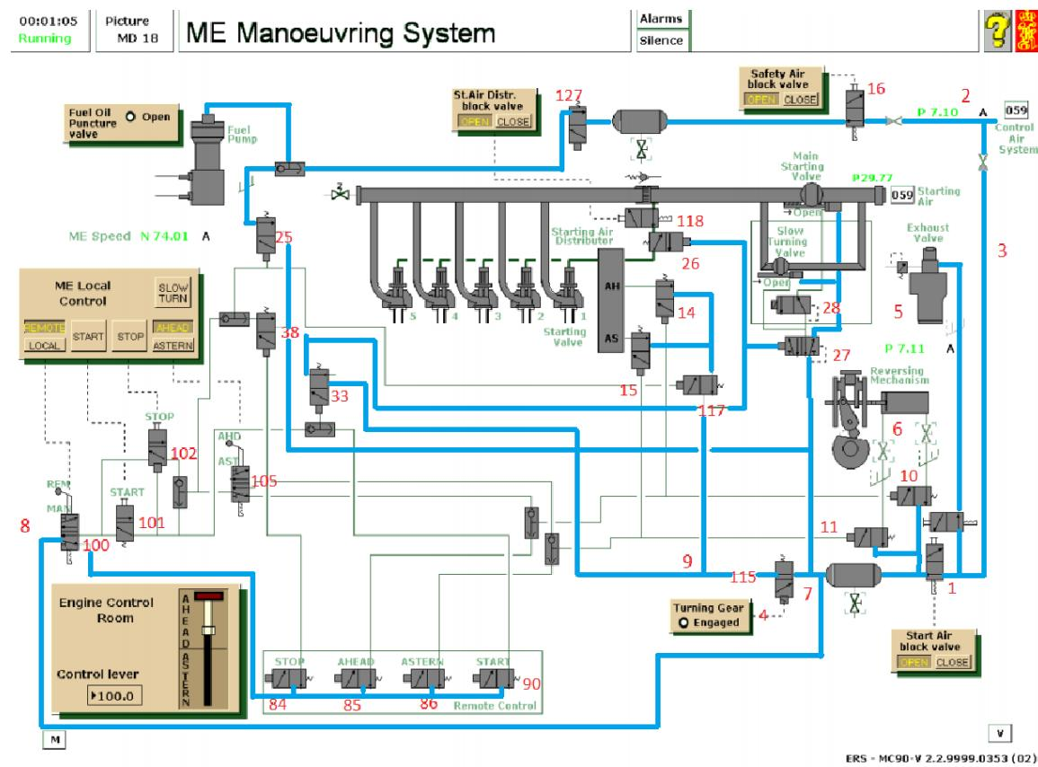
Slika 4. Shema sustava uputnog zraka s označenim cjevovodom [3]
