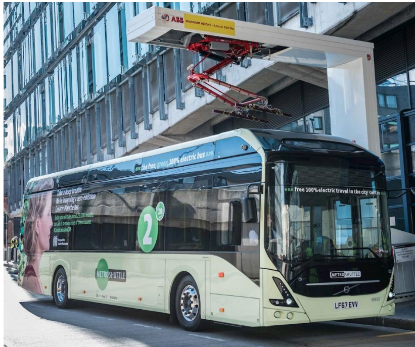
Slika 3. Električni autobus sa stanicom za punjenje [10]
