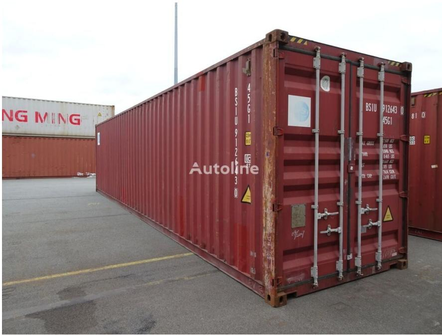
Slika 13. Povišeni kontejneri. „High cube kontejner“ ( preuzeto sa: <https://autoline.hr/prodaja/kontejneri-40-stopa/Seecontainer-Lagercontainer-Reifencontainer--21091411395613414200> )
