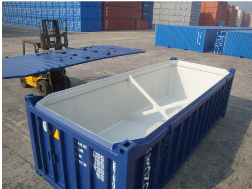
Slika 15. Kontejneri bez čvrstog pokrova „Open top container“ (preuzeto sa:
