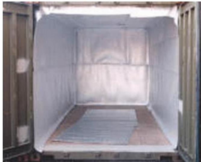
Slika 19. Izolacijski ili temperaturni kontejner „Insulated or termal containers“
