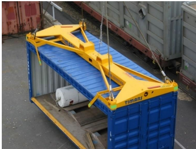
Slika 2. Hvatač kontejnera (engl. Spreader)
