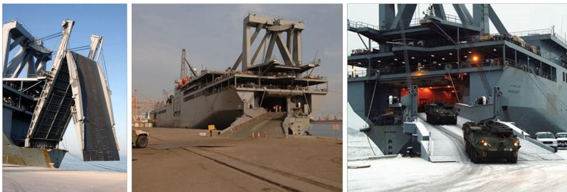
Slika 4. Krmena okretna rampa
