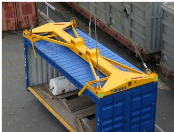
Slika 2. Hvatač kontejnera (engl. Spreader)
