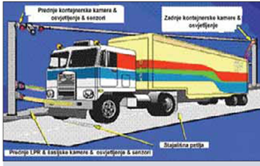
Slika 12. Prikaz komponenata sustava SeaGate
