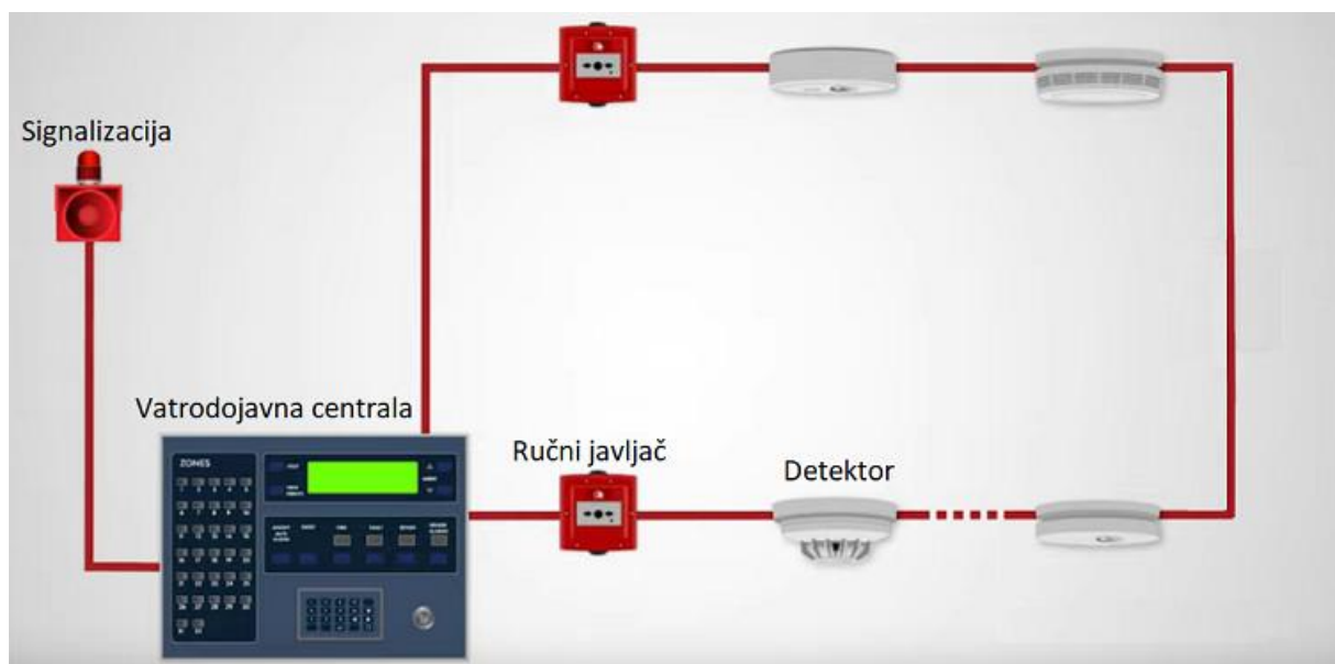
Slika 8. Princip postavljanja broskog vatrodojavnog sustava
