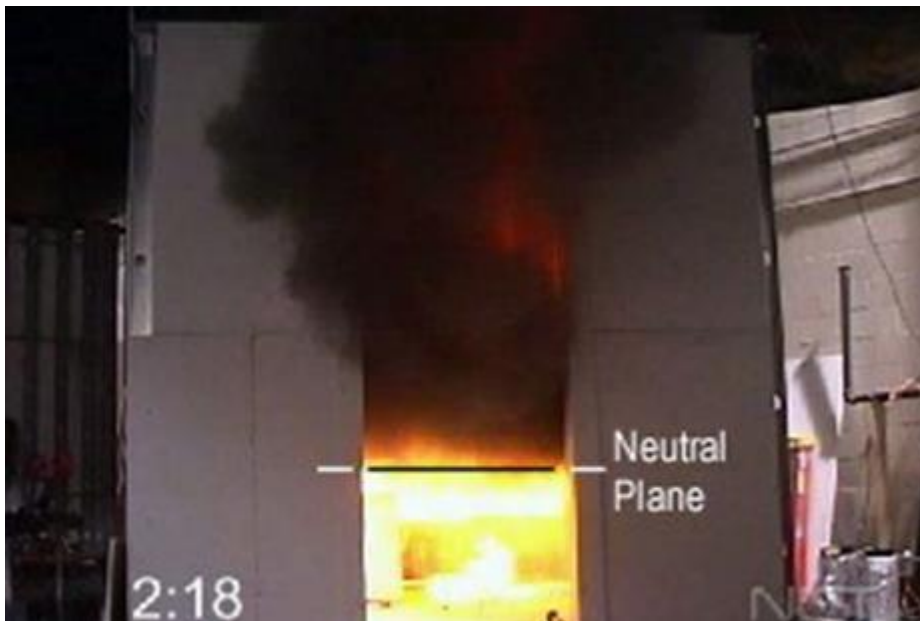
Slika 5. Faza potpuno razvijenog požara
