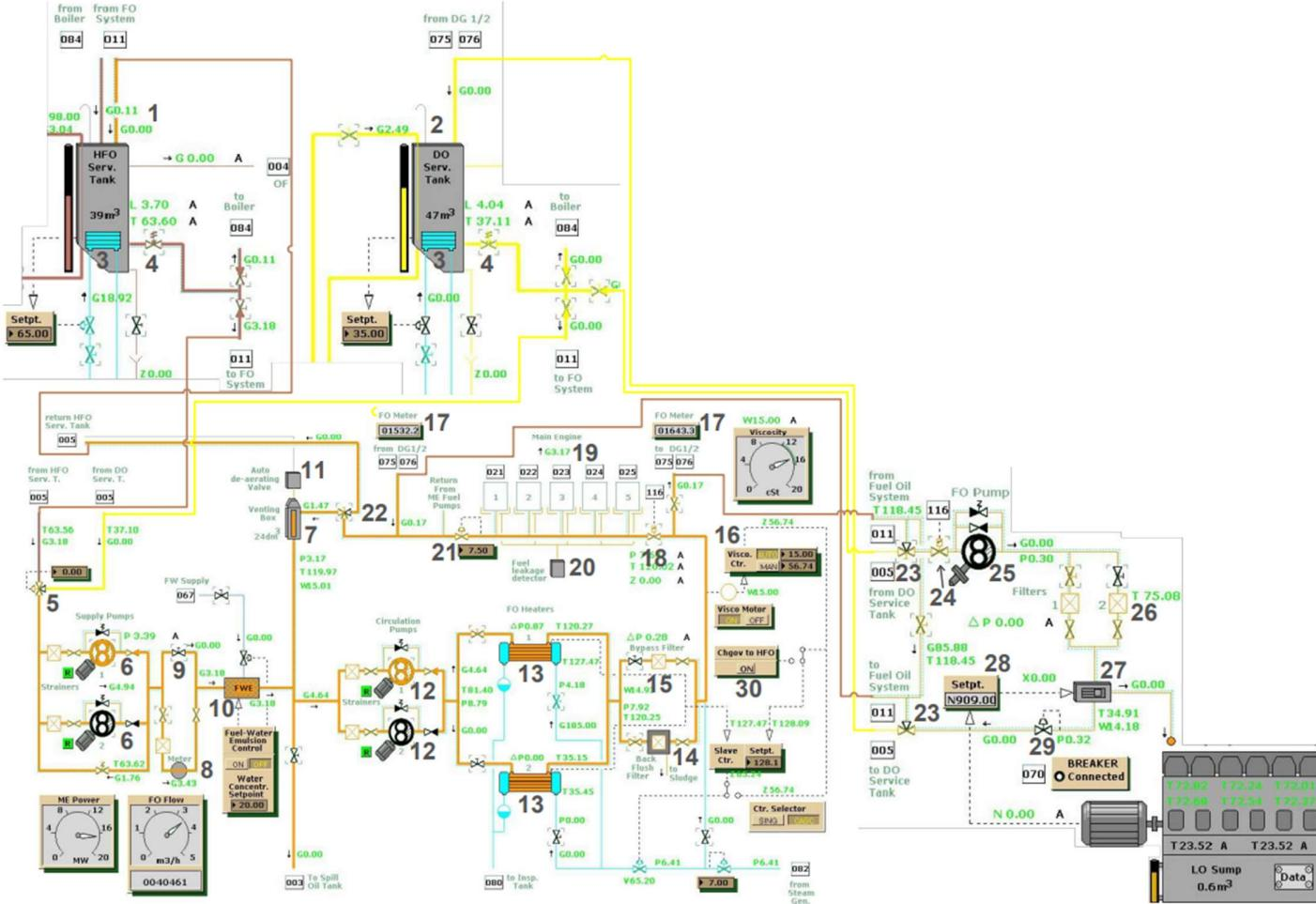
Slika 2. Shema sustava goriva glavnog dizel motora [2]
