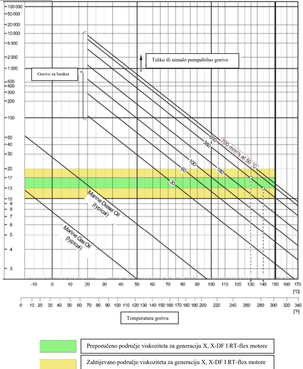
Slika 1. Dijagram viskoziteta i temperature [1]
