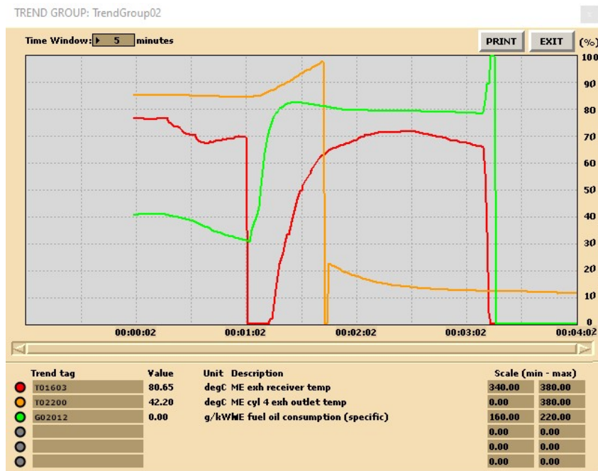
Slika 20. Graf temperature na cilindru 1, temperature prije turbo-puhala i specifične potrošnje goriva tijekom naglog prebacivanja goriva
