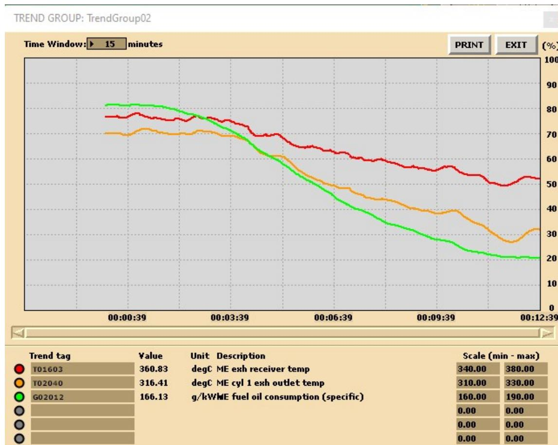
Slika 17. Graf temperature na cilindru 1, temperature prije turbo-puhala i specifične potrošnji goriva tijekom prebacivanja goriva
