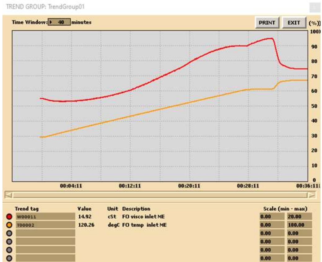
Slika 3. Graf viskoziteta i temperature goriva tijekom prebacivanja goriva
