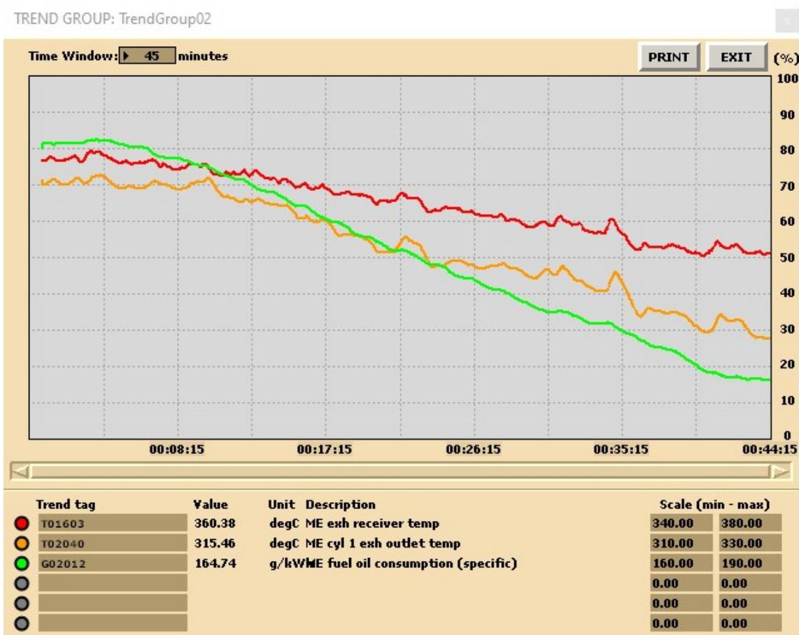
Slika 13. Graf temperature na cilindru 1, temperature prije turbo-puhala i specifične potrošnje goriva tijekom prebacivanja goriva
