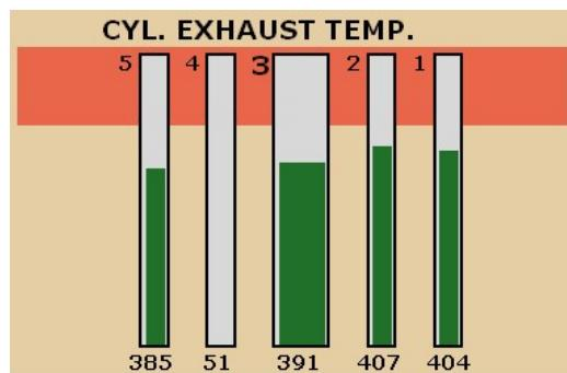
Slika 21. Temperature ispušnih plinova svih cilindara glavnog motora
