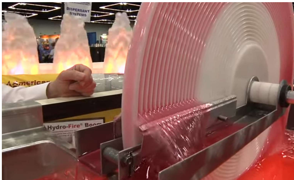
Slika 33. Reljefni disk tokom uklanjanja ulja iz vode
