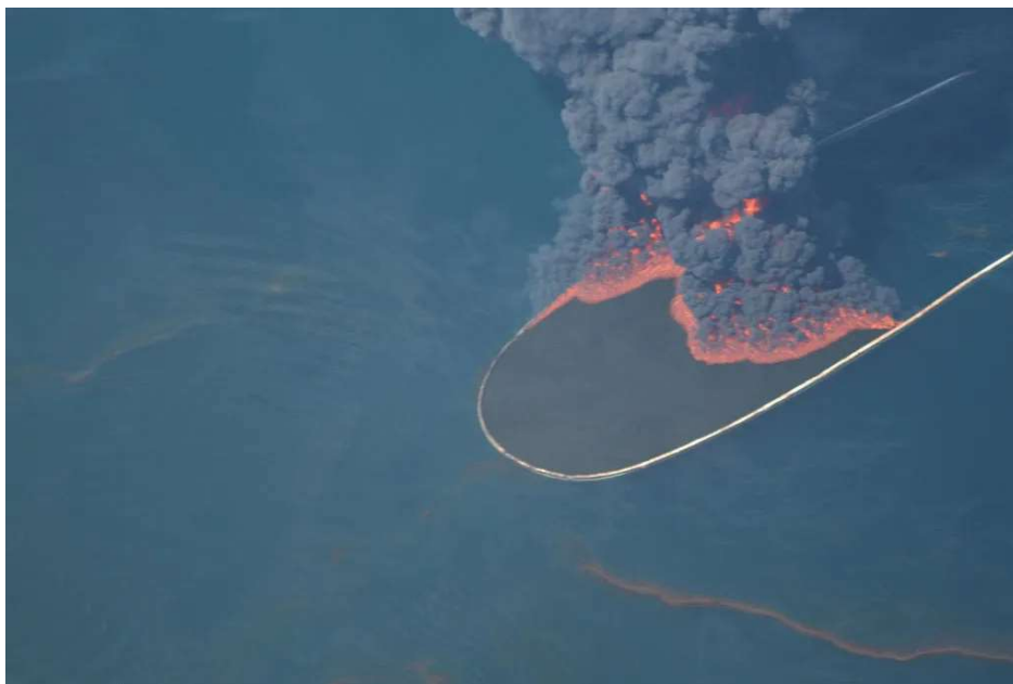
Slika 25. Primjer paljenja uljne mrlje
