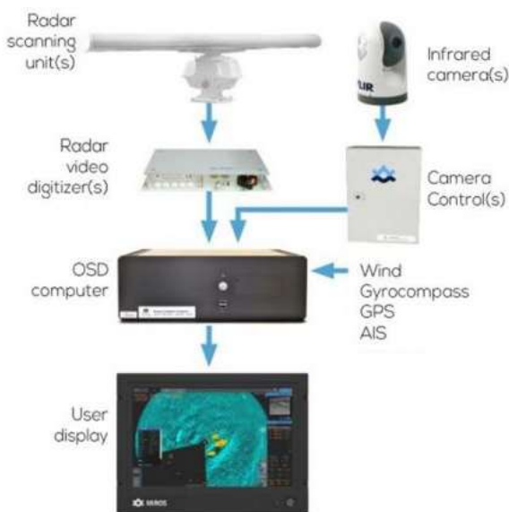
Slika 40. Tijek rada Miros OSD sustava
