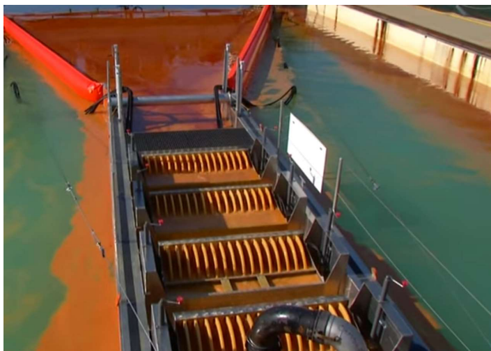
Slika 34. Skimer diskovi tijekom uklanjanja ulja iz vode
