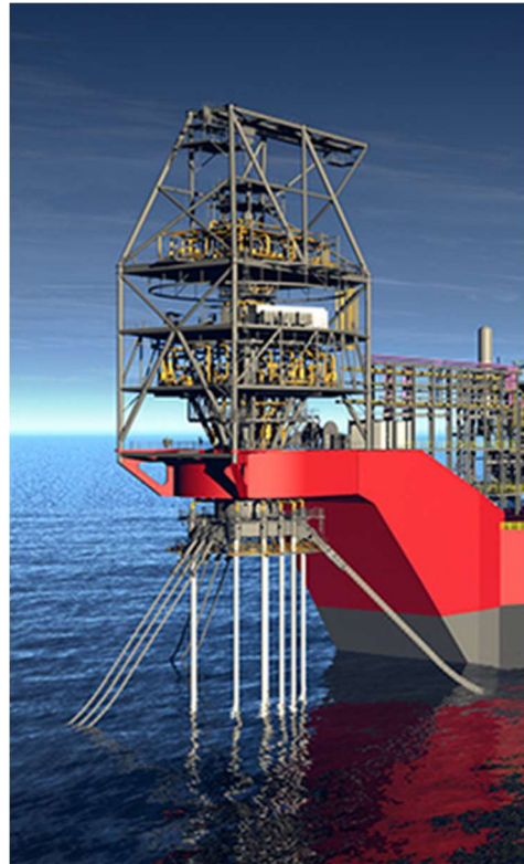
Slika 4. Sidrena kupola, SOFEC
