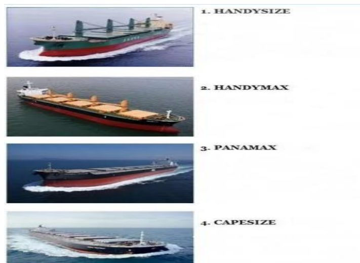
Slika 6. Četiri najzastupljenije vrste broda za rasuti teret
