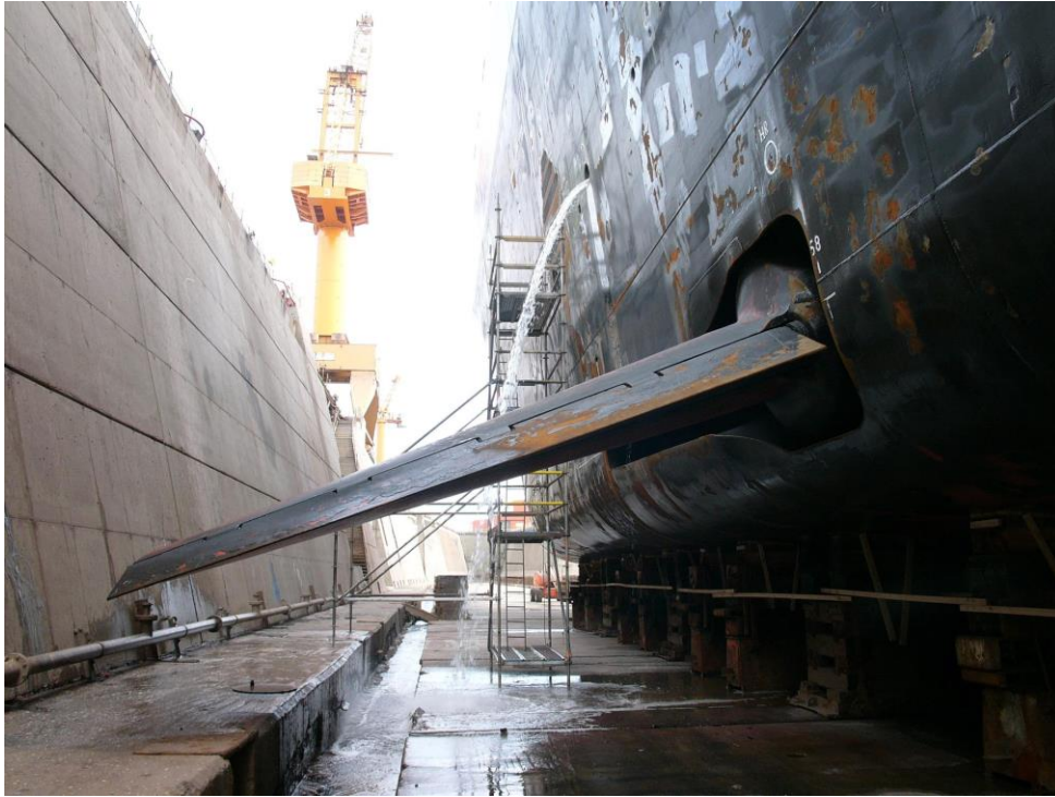
Slika 10 Prikaz aktivnog stabilizatora na putničkom brodu u doku: https://commons.wikimedia.org/wiki/File:Polarstern_stabilizer_hg.jpg (preuzeto: 08.8.2022.)
