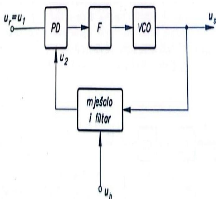
**Slika 8. Blok shema sintetizatora frekvencije s analognom PLL**
