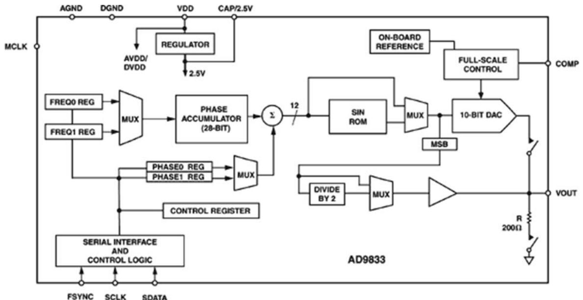
**Slika 6. Blok shema integriranog kruga AD9833**
