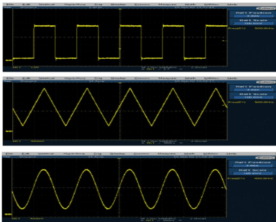
**Slika 5. Spektar izlaznog signala sklopa integriranog kruga AD9833**
