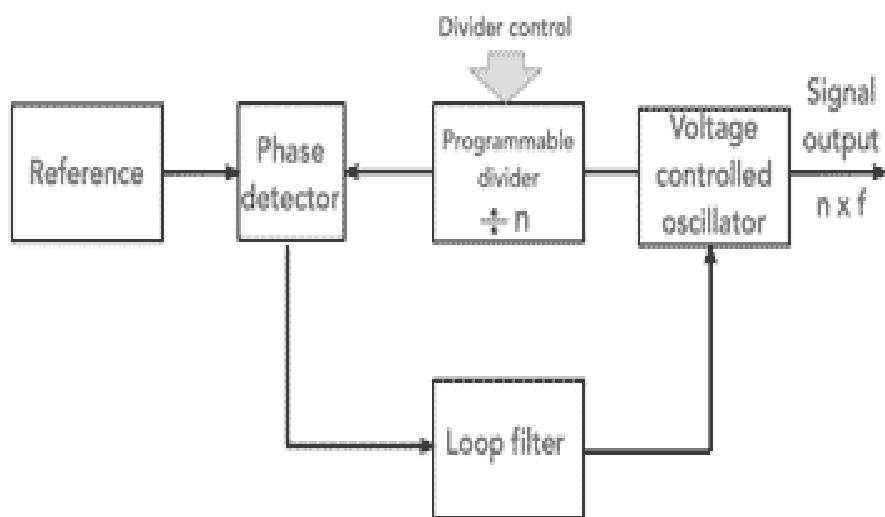
Slika 11. Digitalni sintetizator frekvencije
