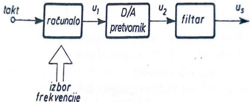
**Slika 3. Blok shema postupka izravne digitalne sinteze signala**
