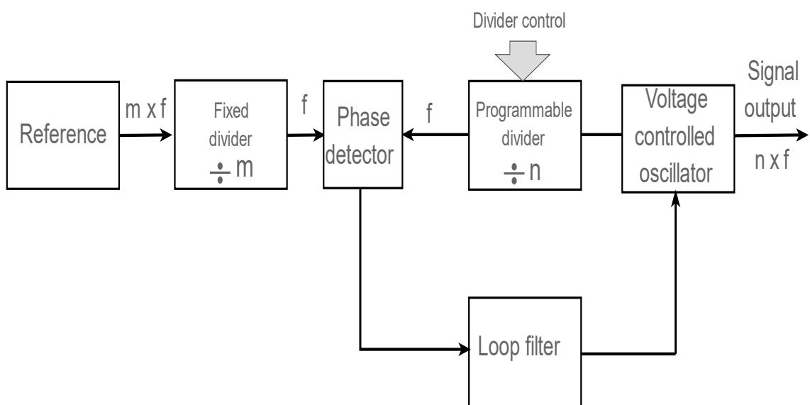
**Slika 13.** Neizravni digitalni sintetizator frekvencije
