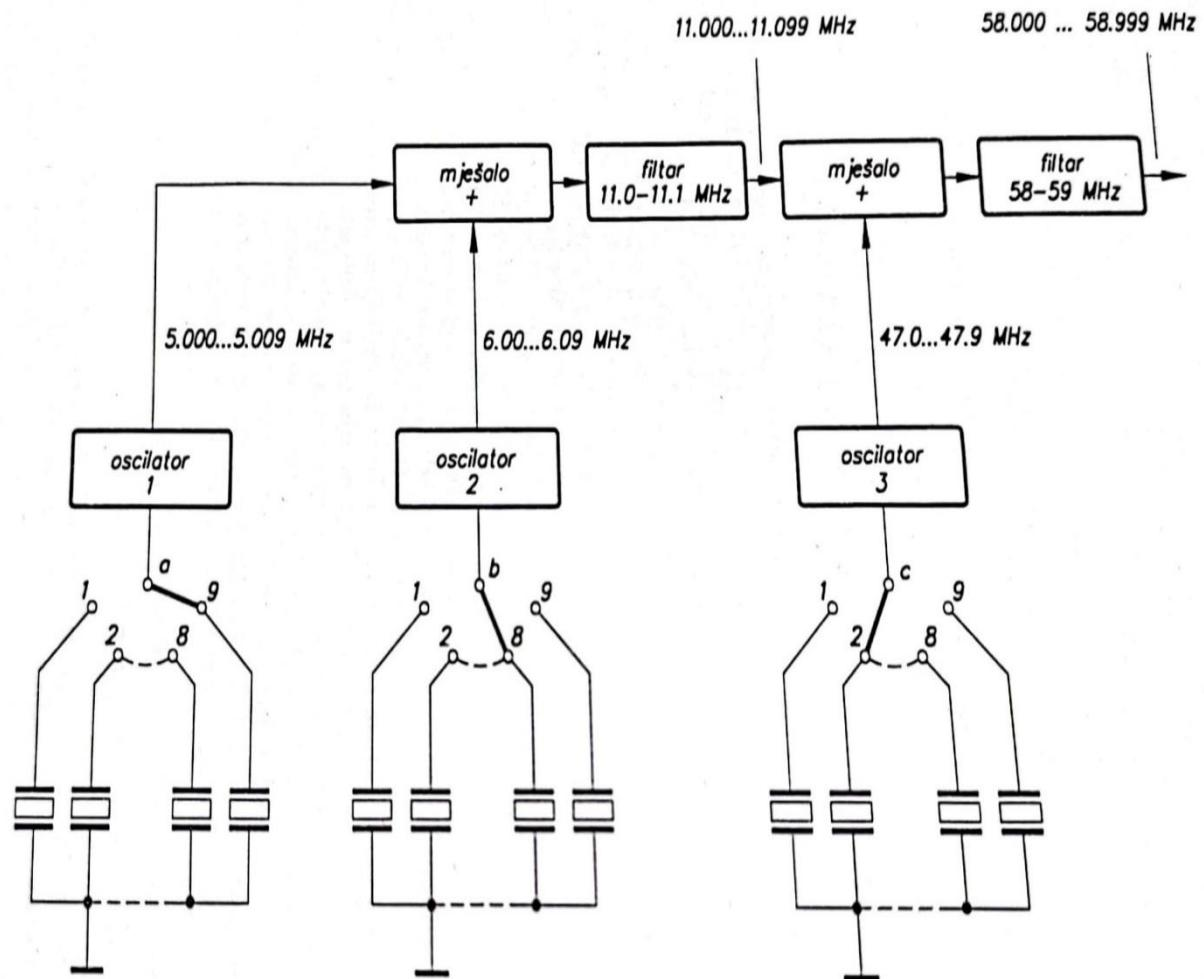
**Slika 2. Blok shema sintetizatora s nekoherentnom izravnom sintezom frekvencije**
