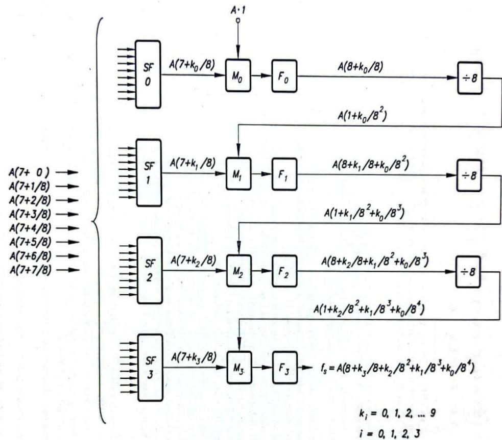
**Slika 15. Primjer sintetizatora koji primjenjuje iterativni postupak izravne sinteze s bazom 8**
