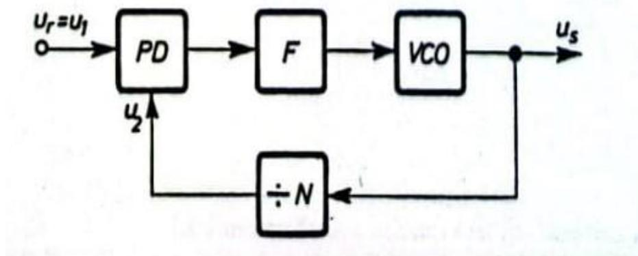
**Slika 10. Blok shema sintetizatora frekvencije s digitalnom fazom sinkroniziranim petljom**
