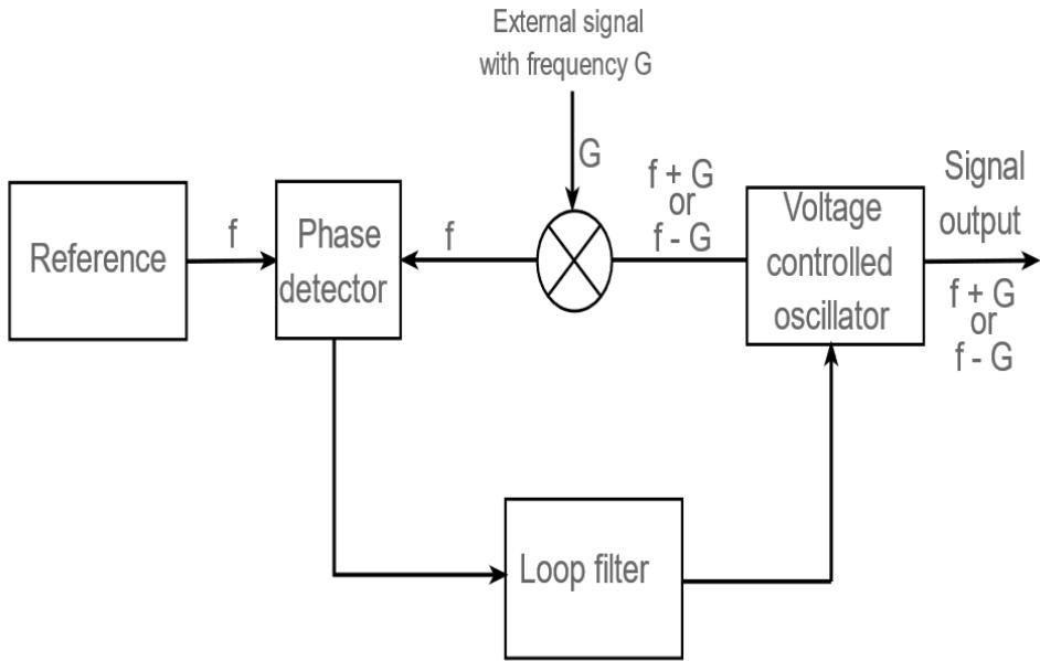
**Slika 9. Blok shema analognog sintetizatora frekvencije**
