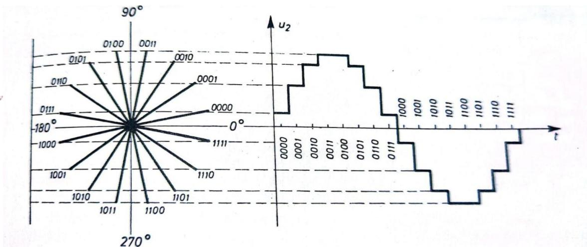
Slika 7. Digitalna sinteza sinusnog signala za  $n = 16$
