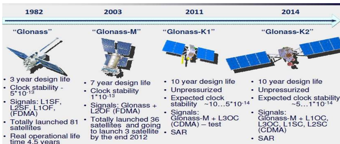
Slika 21. Evolucija ruskog satelita GLONASS kroz prošlo razdoblje
