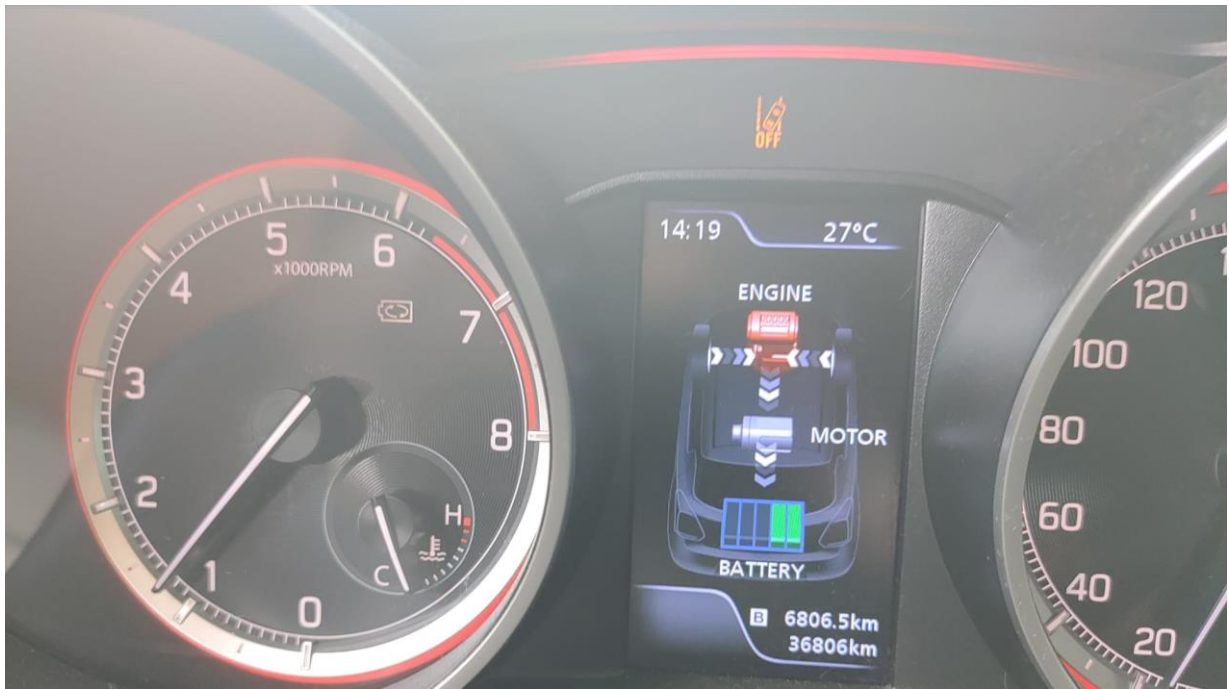
Slika 24. Grafički prikaz rada sustava regenerativnog kočenja
