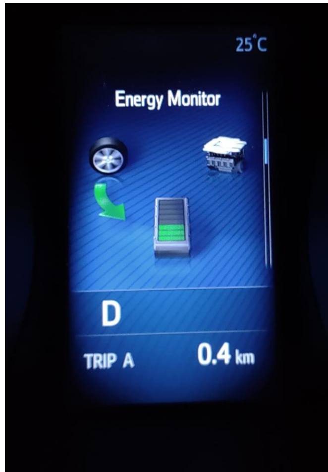
Slika 21. Sustav regenerativnog kočenja – Toyota C-HR
