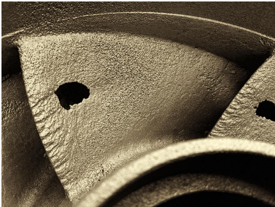
Slika 11- Kavitacija na rotoru
