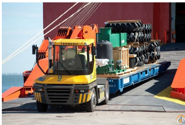
Slika 9. RO-RO tegljač sa priključenom RO-RO prikolicom.
