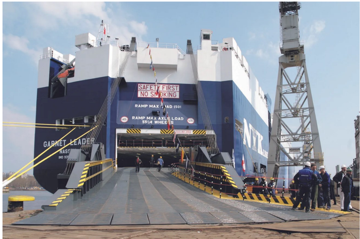
Slika 2. Primjer rampe na krmi broda
