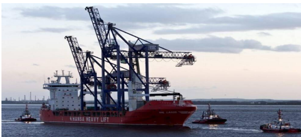
Slika 10. Transport kontejnerskih dizalica na brodu za teške terete
