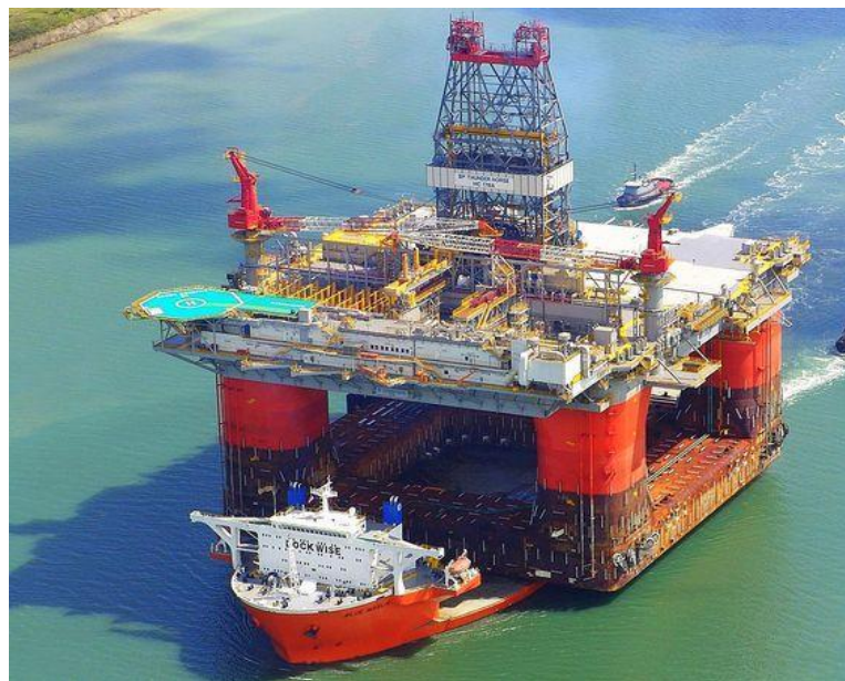
Slika 14. Blue Marlin prevozi platformu Thunder Horse
