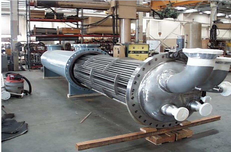
Slika 17: izgled i unutrašnjost isparivača
