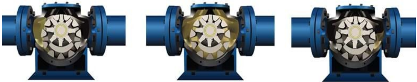
Slika 3. Operacijski ciklus zupčaste pumpe/motora s unutarnjim ozubljenjem [7]
