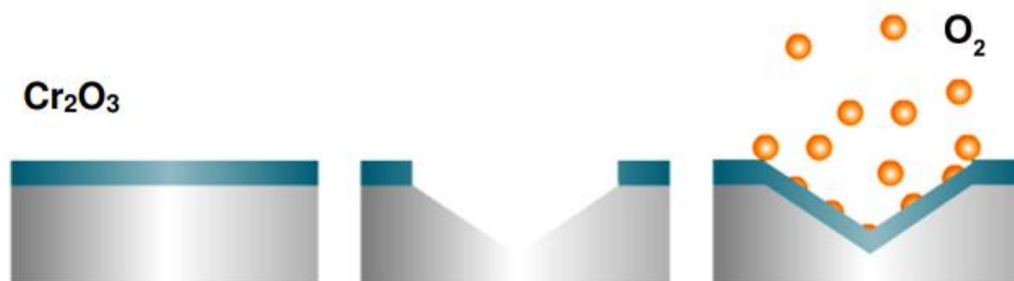
Slika 1. Prikaz spontanog stvaranja oksidnog filma na nehrđajućim čelicima [5]
