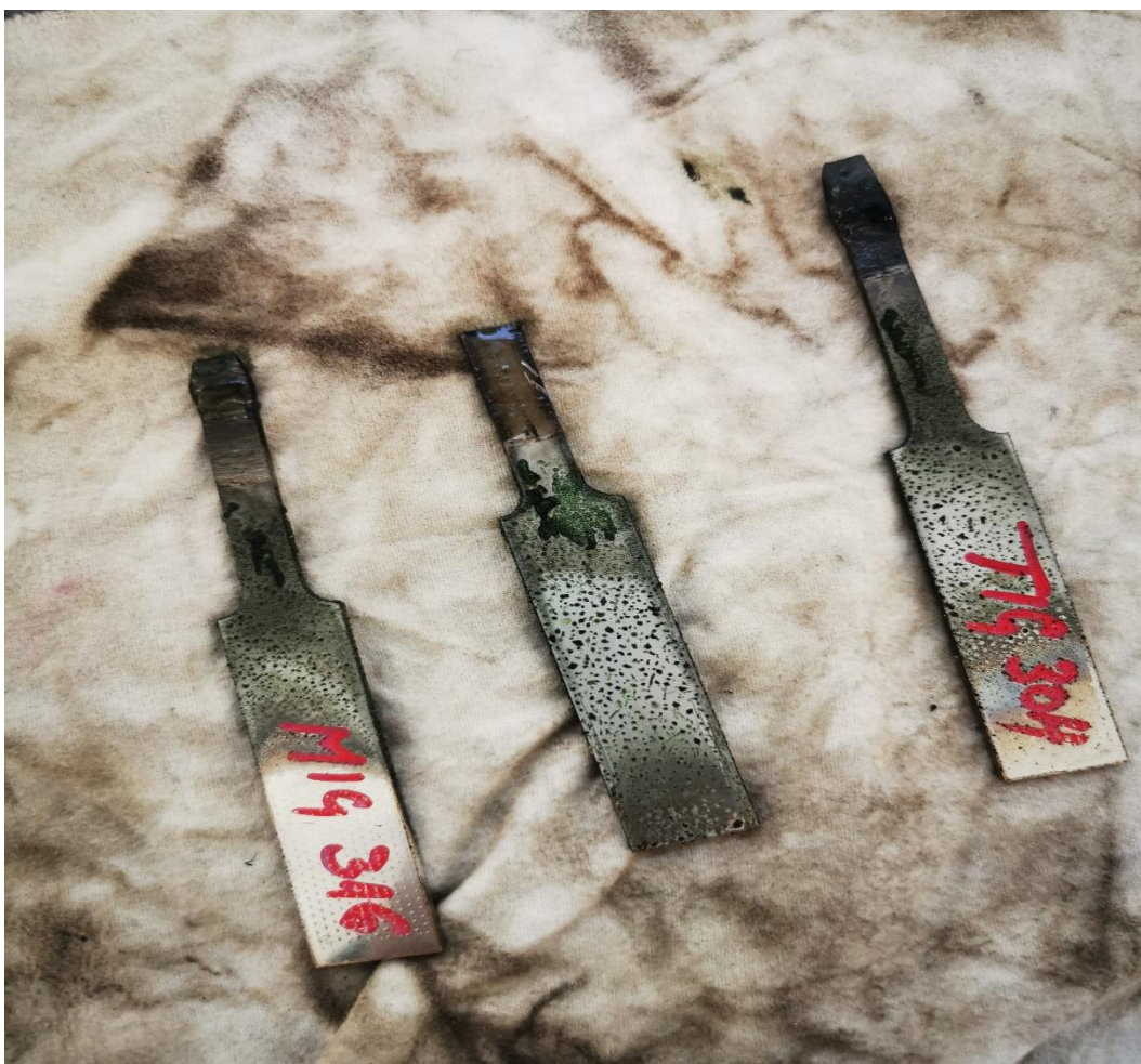
Slika 19. Izgled uzoraka neposredno nakon vađenja iz kiseline
