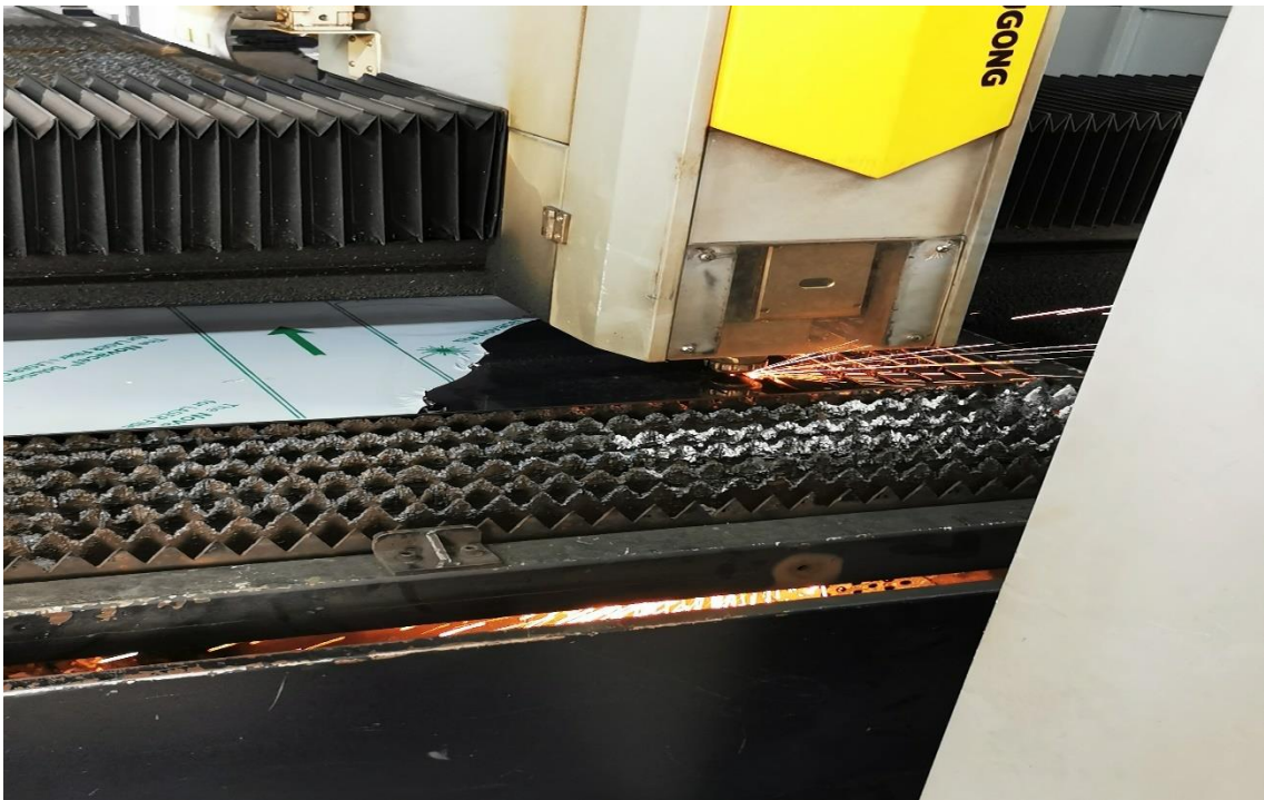
Slika 10. Rezanje epruveta laserom
