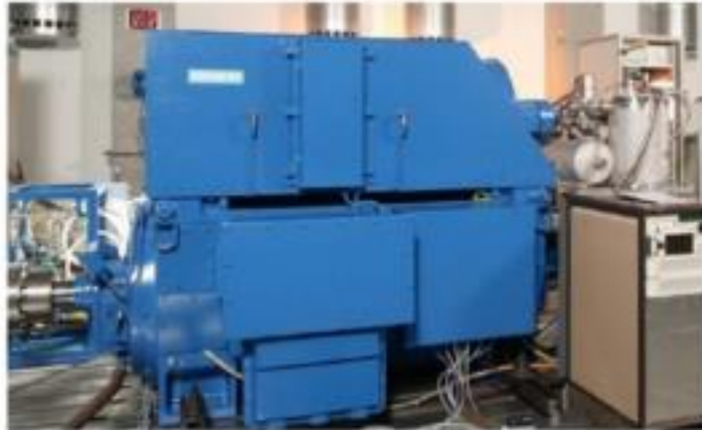
Slika 27. Siemens 4 MVA HTSC generator [61]
