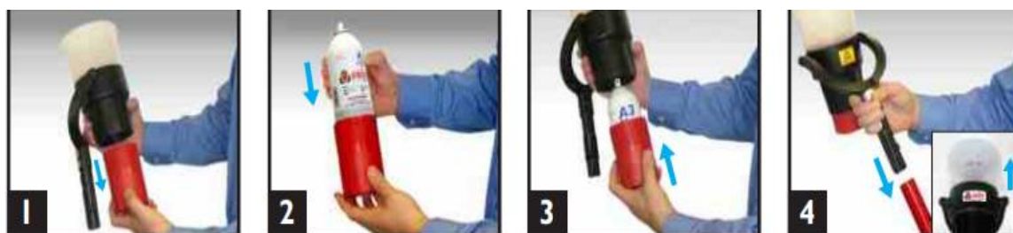
Slika 28 Testiranje detektora dima
