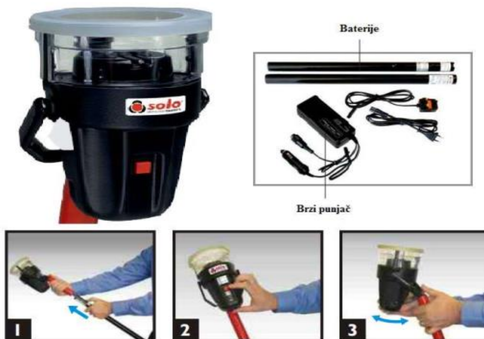
Slika 30 Testiranje toplinskih detektora
