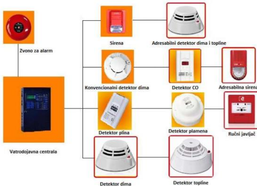
Slika 1 Elementi vatrodjavnog sustava Izvor: https://www.vedard.com/post-fire-detector.html
