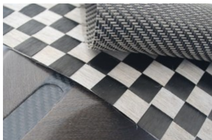
Slika 6 - Hibridna vlakna karbon-lan[5]
