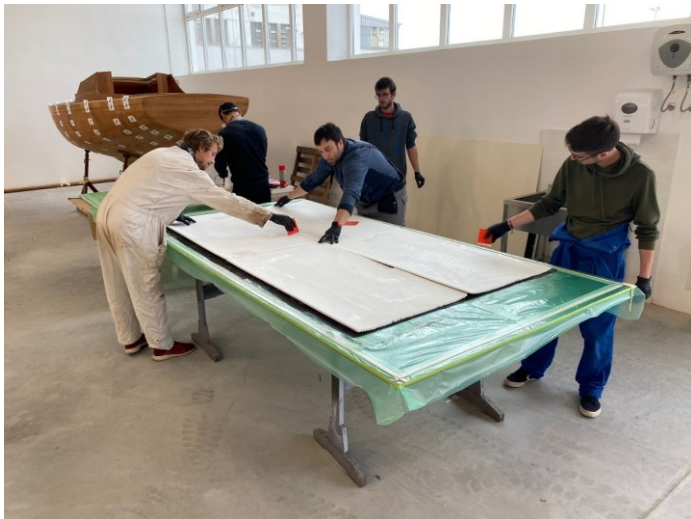
Slika 9 Prikaz procesa vacuum bagging-a
