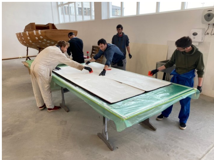
Slika 9 Prikaz procesa vacuum bagging-a
